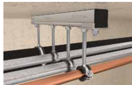
Ľahké, zavesené potrubia
