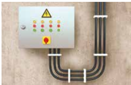
Upevnenie káblových zväzkov
