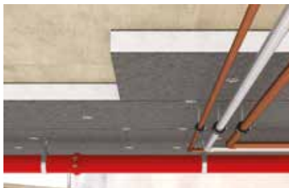
Tlakovo odolné izolačné materiály na spodnej strane stropu
