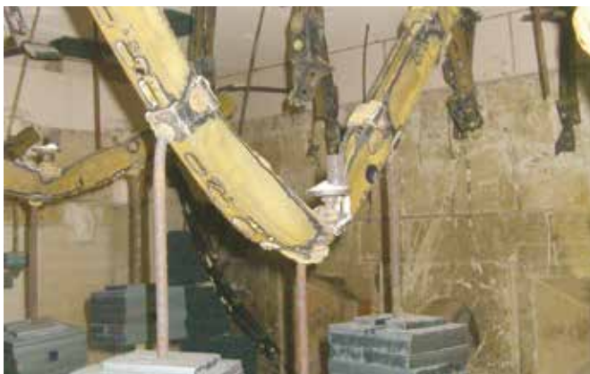
Spalovacia komora pred vykonaním testu
