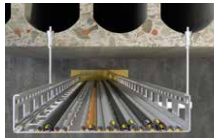
Nosné systémy káblov montované k dutinovým panelom z predpätého betónu
